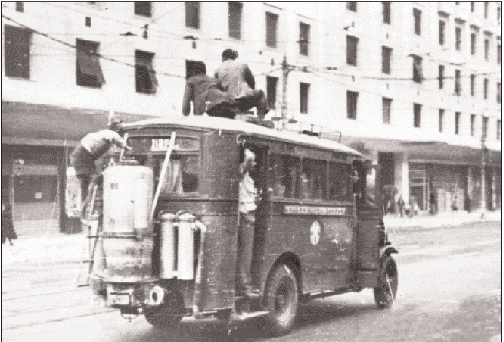
Λεωφορείο γραμμής Ακαδημίας - Ν. Σμύρνης κινείται με το σύστημα «γκαζοζέν» κατά τη διάρκεια της Κατοχής, στην οδό Πανεπιστημίου (φωτ.: Ηνωμένοι Φωτορεπόρτες).
