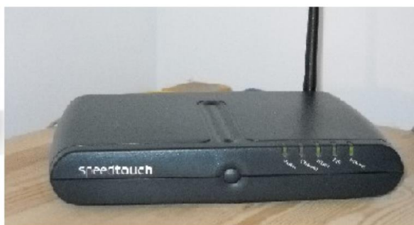
Εικ. 5.12. (α) Επαγγελματικός Δρομολογητής (β) Οικιακός Δρομολογητής aDSL
