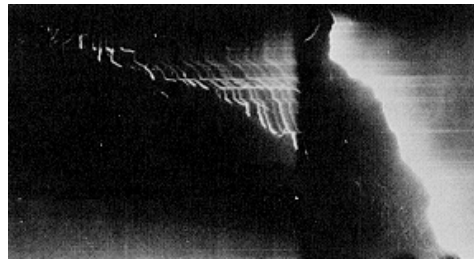
Σχήμα 5.10α Φωτογραφία βηματοδηγού κεραυνού με Streak-camera (ειδική φωτογραφική μηχανή στην οποία το φιλμ κινείται με μεγάλη ταχύτητα έτσι ώστε να διακρίνονται τα διαδοχικά βήματα του οδηγού). Η ένταση του οδηγού (στην αριστερή πλευρά της φωτογραφίας) έχει αυξηθεί τεχνητά, αυξάνοντας το χρόνο της έκθεσης του φιλμ.
