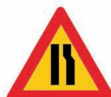
(Κ - 6δ) Επικίνδυνη στένωση οδοστρώ- ματος στην δεξιά πλευρά.
