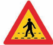
(K - 15) Κίνδυνος λόγω διάβασης πεζών.
