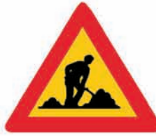
(K - 20) Κίνδυνος λόγω εκτελουμένων εργασιών στην οδό.
