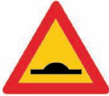
(K - 10) Επικίνδυνα υπερυψωμένο οδόστρωμα ή απότομη κυρτή αλλαγή της κατά μήκος κλίσης της οδού.
