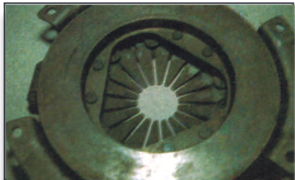
Σχήμα 5: Έλεγχος της πλάκας πίεσης.
