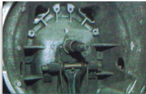
Σχήμα 10: Έλεγχος του πολύσφηνου του πρωτεύοντα άξονα του κιβωτίου ταχυτήτων.
