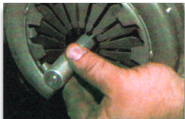
Σχήμα 11: Κεντράρισμα του δίσκου.
