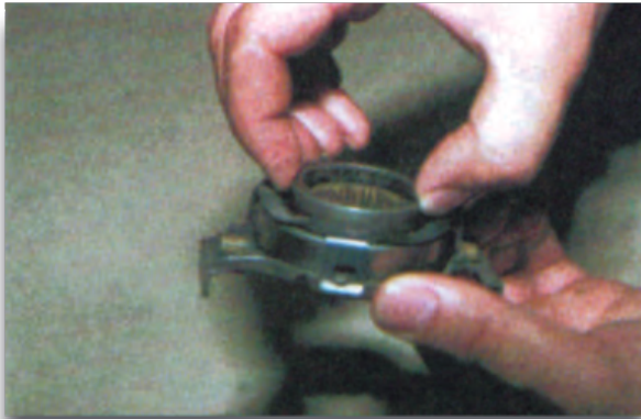
Σχήμα 8: Έλεγχος του ρουλεμάν πίεσης.
