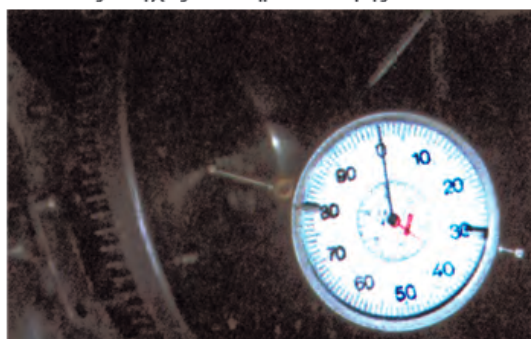
Έλεγχος παραμόρφωσης της επιφάνειας επαφής
