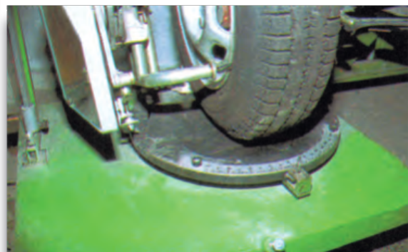
Σχήμα 7: Τοποθέτηση οχήματος στη συσκευή ευθυγράμμισης.
