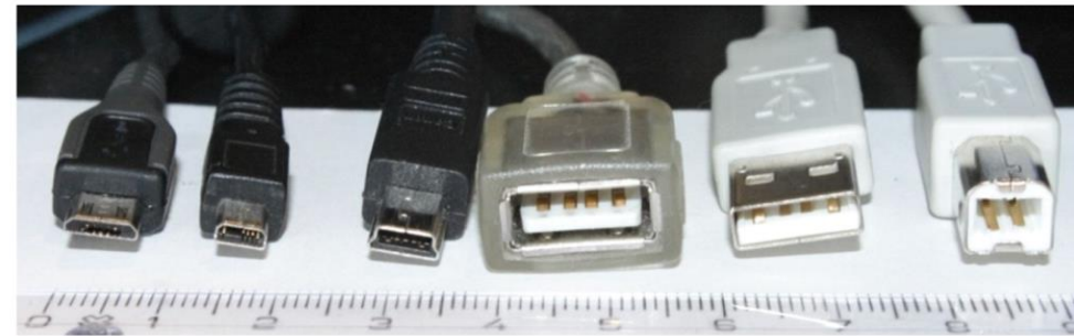
Εικ. 1.18. Διάφοροι τύποι βυσμάτων USB.
