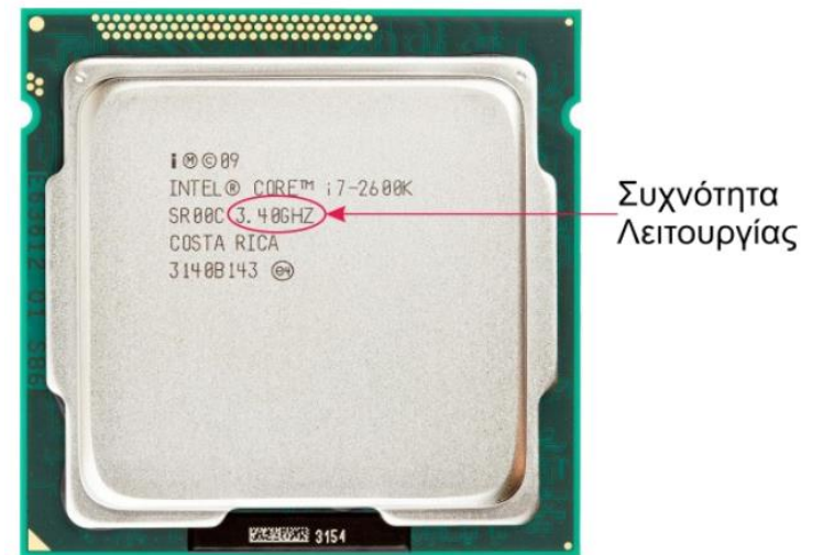
Εικ. 1.7. Επεξεργαστής της INTEL με αναγραφόμενη συχνότητα λειτουργίας τα 3.40 GHz
