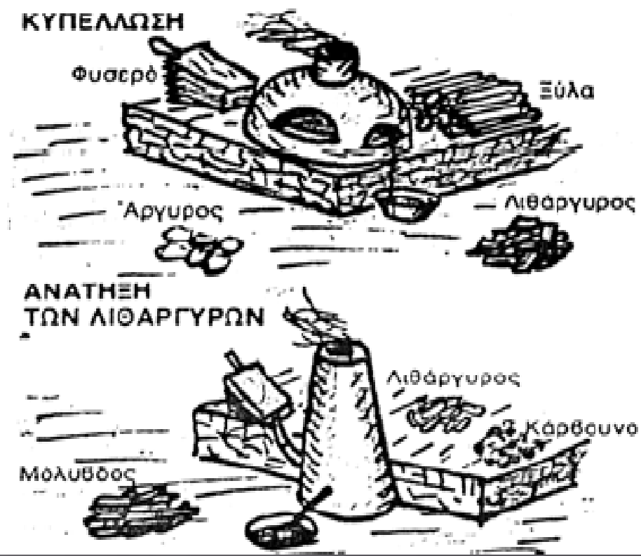
Διάγραμμα κατεργασίας του «αργυρίτου» στο αρχαίο Λαύριο. Το μέταλλευμα μετά την εξόρυξη ακολουθούσε μια πολύπλοκη μεταλλουργική κατεργασία, με τελικό αποτέλεσμα τη λήψη αργύρου και μολύβδου. (Σχέδιο Κ. Κονοφάγου από το βιβλίο του «Το αρχαίο Λαύριο»)
