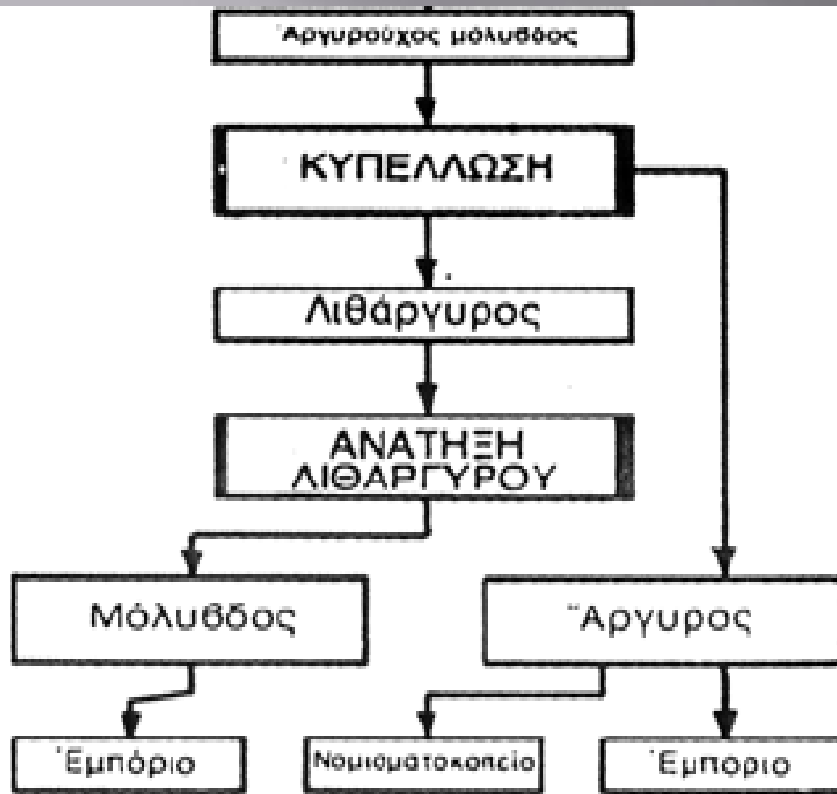
Διάγραμμα κατεργασίας του «αργυρίτου» στο αρχαίο Λαύριο. Το μέταλλευμα μετά την εξόρυξη ακολουθούσε μια πολύπλοκη μεταλλουργική κατεργασία, με τελικό αποτέλεσμα τη λήψη αργύρου και μολύβδου. (Σχέδιο Κ. Κονοφάγου από το βιβλίο του «Το αρχαίο Λαύριο»)
