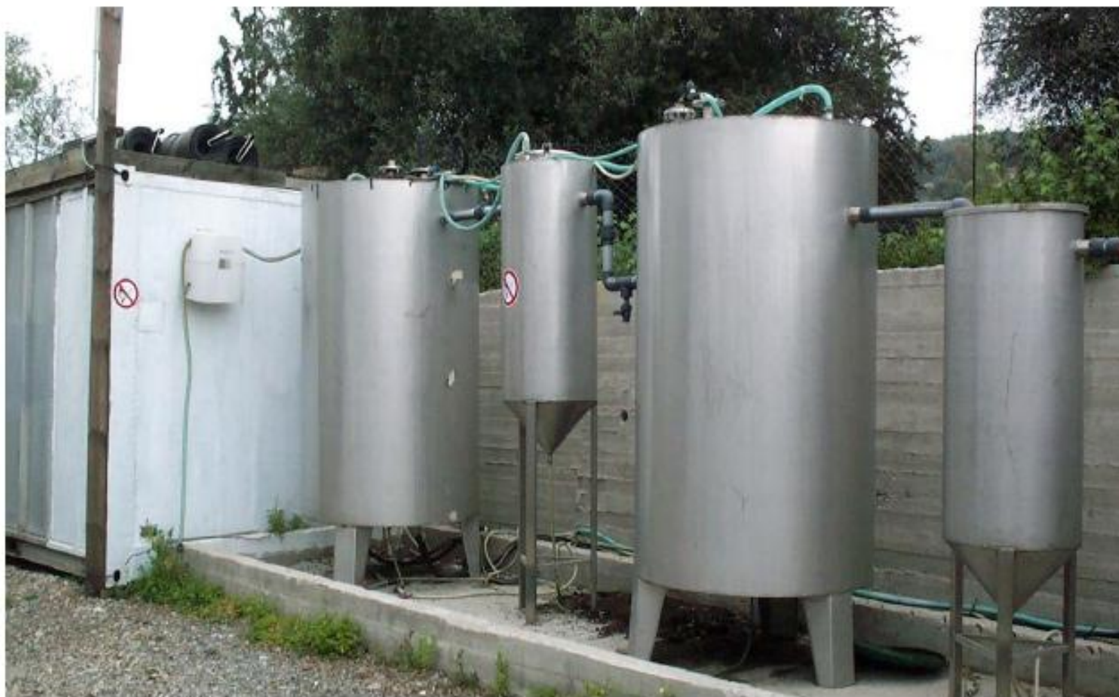
Εικόνα 8. Πιλοτική μονάδα αναερόβιας επεξεργασίας κατσίγαρου (Βαμβακόπουλο Χανιών, Κρήτη)
