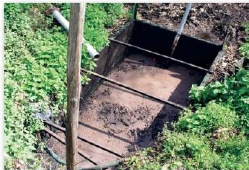
Φωτογραφία 20. Τα απόβλητα του εργοστασίου. Ο πυρήνας χρησιμοποιείται ως καύσιμο (μετά την επεξεργασία του στο πυρηνολαϊουργείο) στο ίδιο το ελαιοτριβείο για να θερμάνει νερό ενώ τα υγρά (απόνερα) μετά την τελευταία φυγοκέντριση καταλήγουν σε δεξαμενή.
