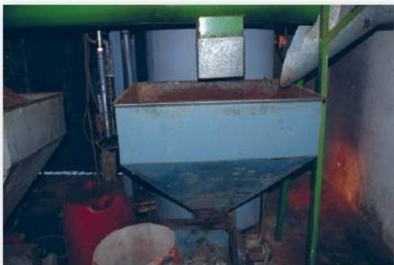
Φωτογραφία 20. Τα απόβλητα του εργοστασίου. Ο πυρήνας χρησιμοποιείται ως καύσιμο (μετά την επεξεργασία του στο πυρηνολαϊουργείο) στο ίδιο το ελαιοτριβείο για να θερμάνει νερό ενώ τα υγρά (απόνερα) μετά την τελευταία φυγοκέντριση καταλήγουν σε δεξαμενή.
