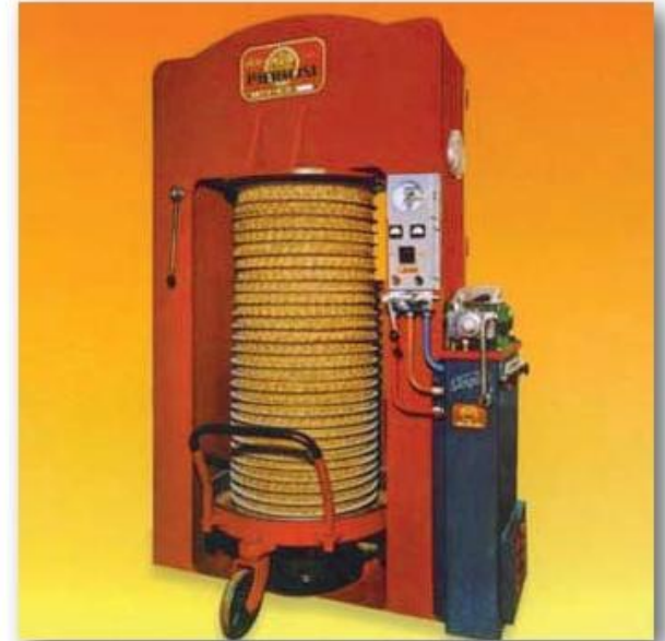
Φωτογραφία 11. Παλιός και σύγχρονος τύπος πιεστηρίου με τους ελαιόσακους έτοιμους για την άσκηση πίεσης.
