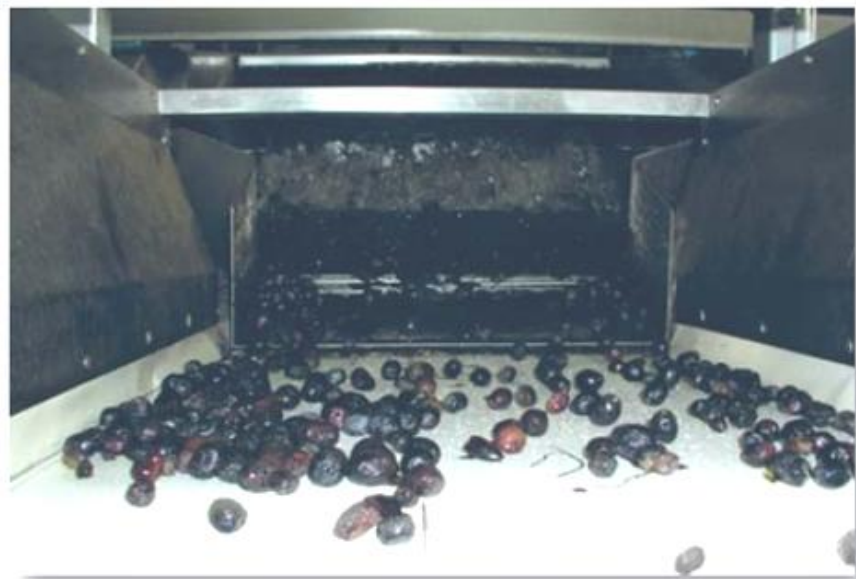
Φωτογραφία 6. Μετά το πλύσιμο, οι ελιές, με ιμάντα (αριστερά) ή ή κοχλία-αναβατόριο κατευθύνονται προς την εκθλιπτική μηχανή ή σπαστήρα (δεξιά).
