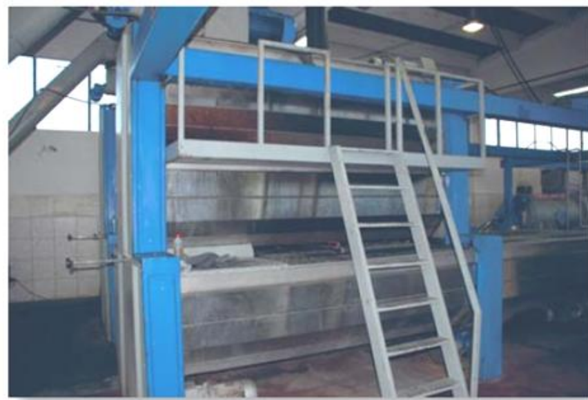
Φωτογραφία 6. Μετά το πλύσιμο, οι ελιές, με ιμάντα (αριστερά) ή ή κοχλία-αναβατόριο κατευθύνονται προς την εκθλιπτική μηχανή ή σπαστήρα (δεξιά).
