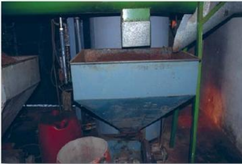
Φωτογραφία 20. Τα απόβλητα του εργοστασίου. Ο πυρήνας χρησιμοποιείται ως καύσιμο (μετά την επεξεργασία του στο πυρηνολιουργείο) στο ίδιο το ελαιοτριβείο για να θερμάνει νερό ενώ τα υγρά (απόνερα) μετά την τελευταία φυγοκέντριση καταλήγουν σε δεξαμενή.
