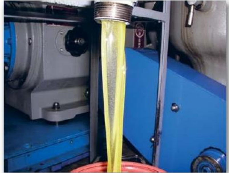
Φωτογραφία 17. Τελικός διαχωρισμός στους κάθετους φυγοκεντρωτές όπου διαχωρίζεται το λάδι από το νερό (τελικός καθαρισμός του ελαιόλαδου).
