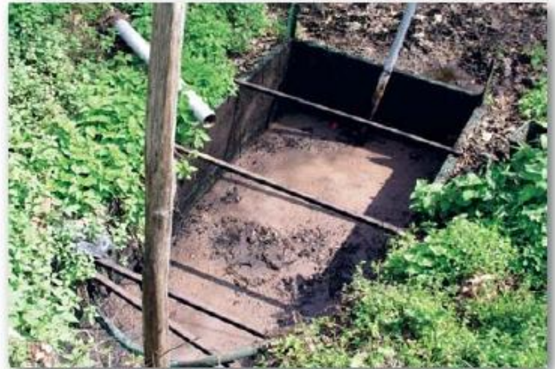
Φωτογραφία 20. Τα απόβλητα του εργοστασίου. Ο πυρήνας χρησιμοποιείται ως καύσιμο (μετά την επεξεργασία του στο πυρηνολιουργείο) στο ίδιο το ελαιοτριβείο για να θερμάνει νερό ενώ τα υγρά (απόνερα) μετά την τελευταία φυγοκέντριση καταλήγουν σε δεξαμενή.
