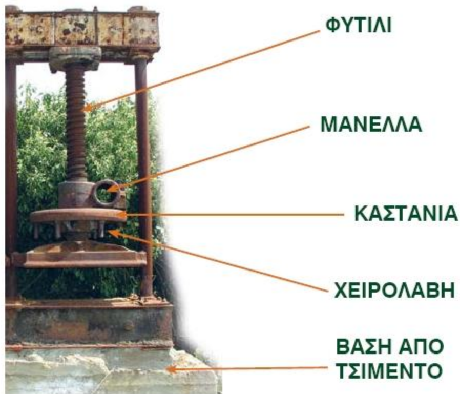
Σχήμα 1. Η ονομασία των κύριων τμημάτων ενός πιεστηρίου τύπου με «μανέλλα».
