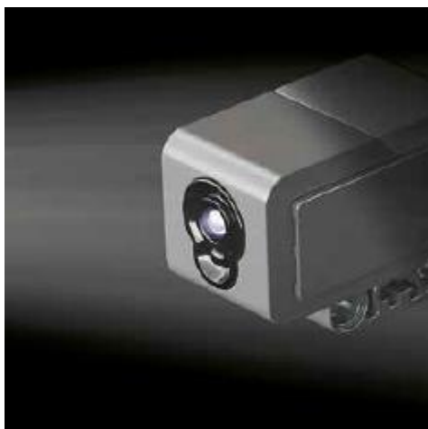
Εικόνα 2. 8 Λειτουργία έντασης ανακλώμενου φωτός (Reflected Light Intensity Mode)
