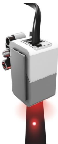
Εικόνα 2. 7 Λειτουργία έντασης ανακλώμενου φωτός (Reflected Light Intensity Mode)
