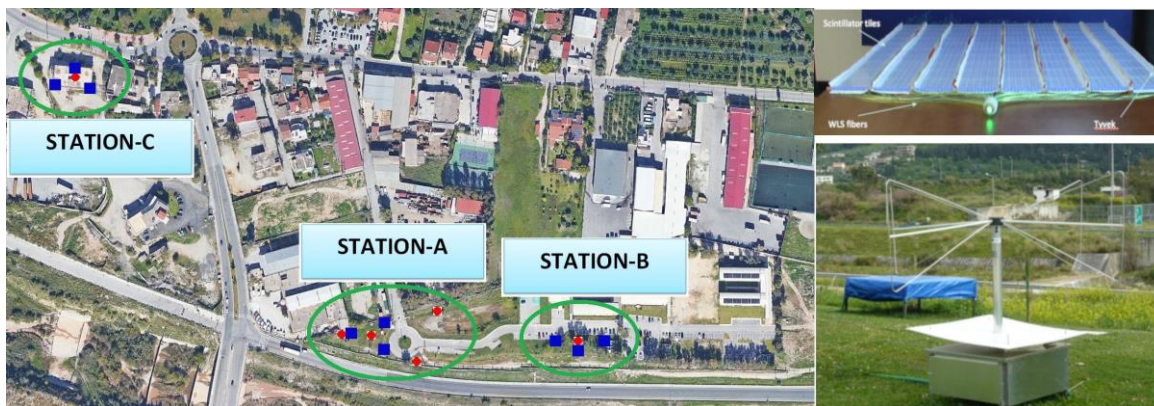
Εικόνα 3: Στην αριστερή φωτογραφία φαίνονται τρεις σταθμοί του δικτύου Astroneu. Τα μπλε τετράγωνα αναπαριστούν τους ανιχνευτές σωματιδίων κάθε σταθμού, ενώ οι κόκκινοι κύκλοι τις κεραίες ανίχνευσης ραδιοκυμάτων. Στην δεξιά πάνω φωτογραφία φαίνεται η εσωτερική δομή του ανιχνευτή σωματιδίων ενώ στη κάτω δεξιά φωτογραφία φαίνονται η κεραία και ο ολοκληρωμένος ανιχνευτής σωματιδίων (μπλε κουτί).
