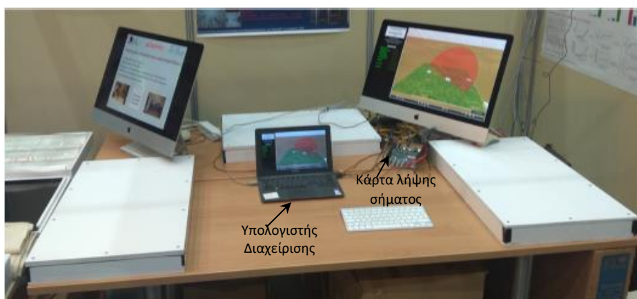
Εικόνα 4: Το ανιχνευτικό σύστημα Κοσμικών Ακτίνων \mu\text{Cosmics} . Τα λευκά κουτιά (διάσταση 67 \times 42 \times 7 \text{ cm}^3 ) είναι οι ανιχνευτικές μονάδες του τηλεσκοπίου.
