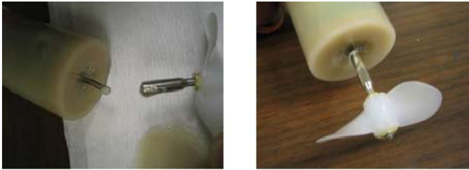
Εικόνα 2.25. Τοποθέτηση της προπέλας στον άξονα του κινητήρα.
