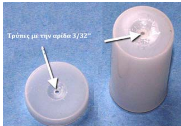
Εικόνα 2.7. Δοχείο και καπάκι με τρύπες ακριβώς στο κέντρο.
