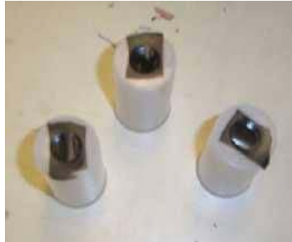
Εικόνα 2.13. Κάλυψη της τρύπας του δοχείου με μονωτική ταινία.
