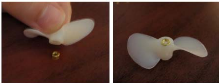
Εικόνα 2.22. Τοποθέτηση των παξιμαδιών στις προπέλες.
