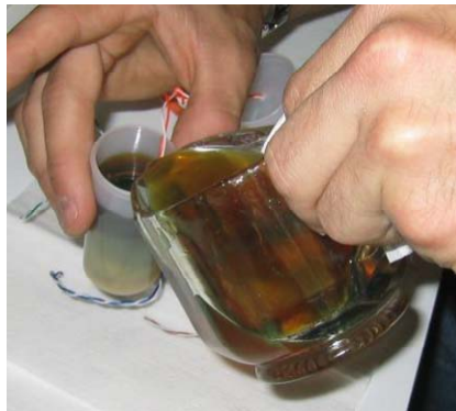
Εικόνα 2.17. Προσθήκη επιπλέον λιωμένου κεριού στο δοχείο με τον κινητήρα.
