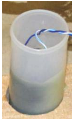
Εικόνα 2.16. Τοποθέτηση του κινητήρα στο δοχείο με το κερί.
