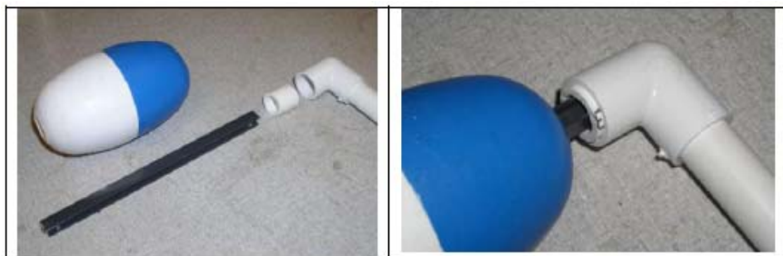
Εικόνα 1.6. Τρόπος κατασκευής των πλωτήρων πλεύσης.
