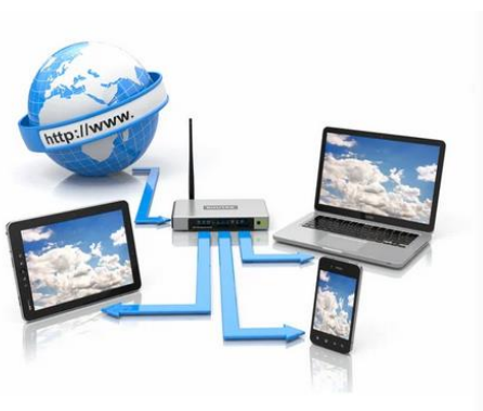
Εικόνα 2.8. Δημιουργία WLAN με Access Point ενσωματωμένο στον οικιακό δρομολογητή
