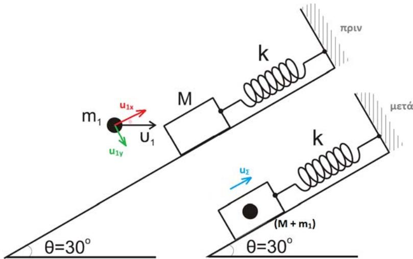
$$\text{Από Α.Δ.Ο. } \vec{P}_{\text{πριν}} = \vec{P}_{\mu\text{ετά}} \Rightarrow m_1 \cdot u_{1x} = (M + m_1) \cdot u_\Sigma \Rightarrow$$
