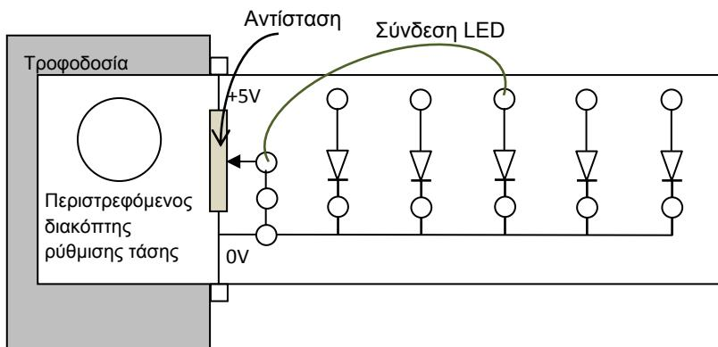
Στον πίνακα μετρήσεων φαίνεται η ελάχιστη τάση  $V_o$  που απαιτείται να εφαρμοστεί στα άκρα των LED για να αρχίσουν οριακά να φωτοβολούν. Οι LED που χρησιμοποιούνται στο
