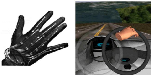
Εικόνα 6. Γάντι Αίσθησης και επίδραση στο εικονικό περιβάλλον (δύναμη στο τιμόνι)
