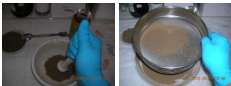
Εικόνα 3. Το χώμα ομογενοποιείται και κοσκινίζεται από κόσκινο 63 μm.
