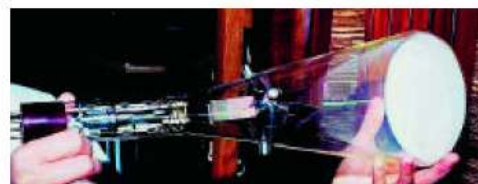
Σχήμα 2.24: Πειραματικός σωλήνας Braun.
