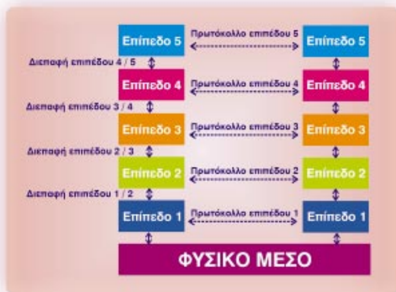
Σχήμα 5.9: Δίκτυο πέντε επιπέδων (επίπεδα - πρωτόκολλα - διεπαφές)
