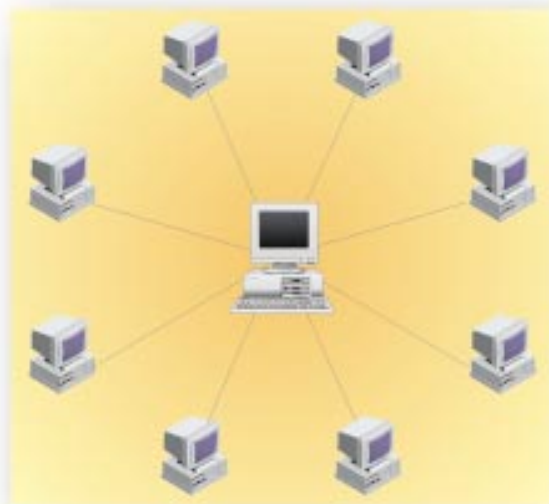
Σχήμα 3.2: Διάταξη άστρου. Κάθε σύνδεση τερματικού προς τον κεντρικό υπολογιστή αποτελεί γραμμή επικοινωνίας σημείου προς σημείο.
