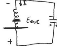
$$\text{b) } t=0 \text{ παρείχω } q=0 \Rightarrow q=Q \text{ στην } t=0 \text{ } \Rightarrow t = \frac{T}{4} \Rightarrow \boxed{t = \frac{\pi \cdot 10^{-3}}{2} \text{ s}}$$
