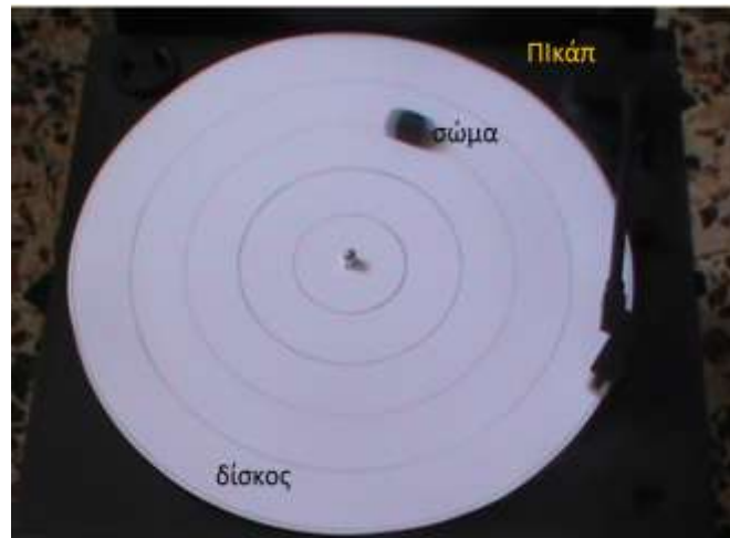
Εικόνα 1: Συσκευή πραγματοποίησης ομαλής κυκλικής κίνησης (πικάπ)
