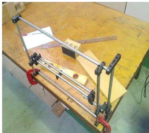
Εικόνα 7. Εξαρτήματα της διάταξης κεκλιμένου επιπέδου από την σειρά οργάνων μηχανικής
