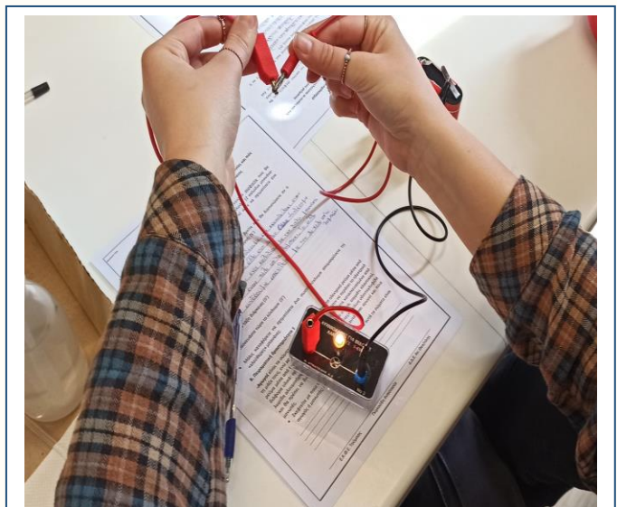
Εικόνα 2. Κατασκευή και έλεγχος λειτουργίας ηλεκτρικού κυκλώματος.
