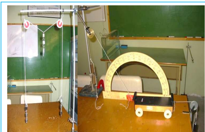
Εικόνα 4. Διατάξεις για τον υπολογισμό της συνισταμένης δύναμης (αριστερά) και συνιστώσας δύναμης (δεξιά)
