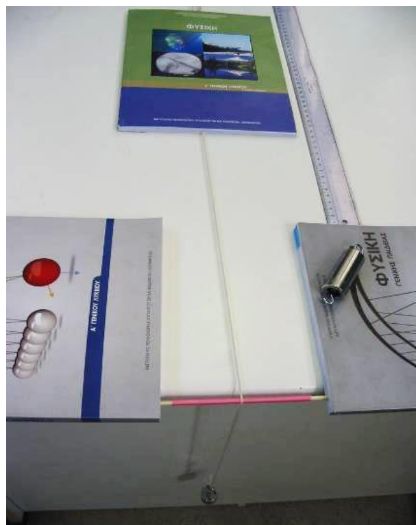
Εικόνα 6. Διάταξη με απλά υλικά όπου το βαρίδι κινείται με την επίδραση σταθερών δυνάμεων.
