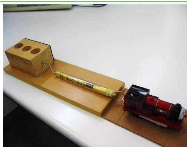
Εικόνα 5. Παιδικό τραινάκι, δυναμόμετρο και επιφάνειες, για τη μελέτη των ιδιοτήτων της τριβής
