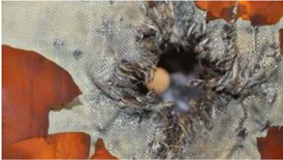
Σχήμα 4. Η θωράκιση αυτοματοποιημένου οχήματος μεταφοράς μετά από δοκιμή πρόσκρουσης.
