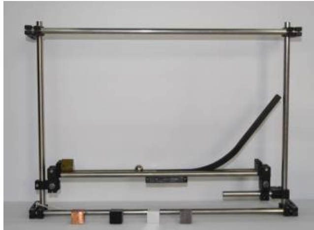
Σχήμα 5. Η πειραματική διάταξη για τη μελέτη αντοχής στις συγκρούσεις.
