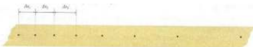
Σχήμα 6 Στην επιταχυνόμενη κίνηση τα διαστήματα μεταξύ των κουκκίδων συνεχώς μεγαλώνουν ( \Delta x_1 < \Delta x_2 < \Delta x_3 < \dots )
