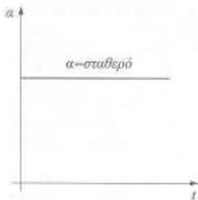
Σχήμα 1 Η επιτάχυνση a στην ευθύγραμμη ομαλά επιταχυνόμενη κίνηση είναι σταθερή.
