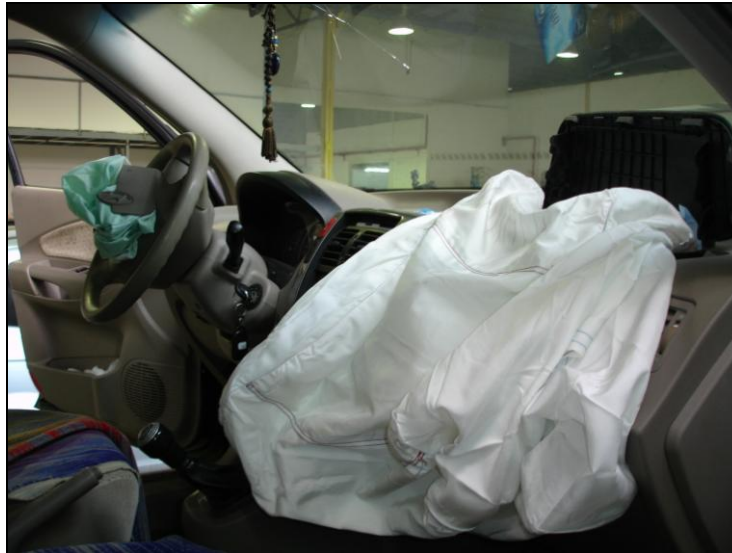
Εικόνα 36: Αερόσακοι ενεργοποιημένοι μετά από ατύχημα σε όχημα.
