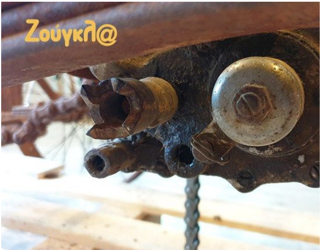
Η εκκίνηση του μηχανικού συνόλου γινόταν περιστρέφοντας τον αριστερό διακόπτη
