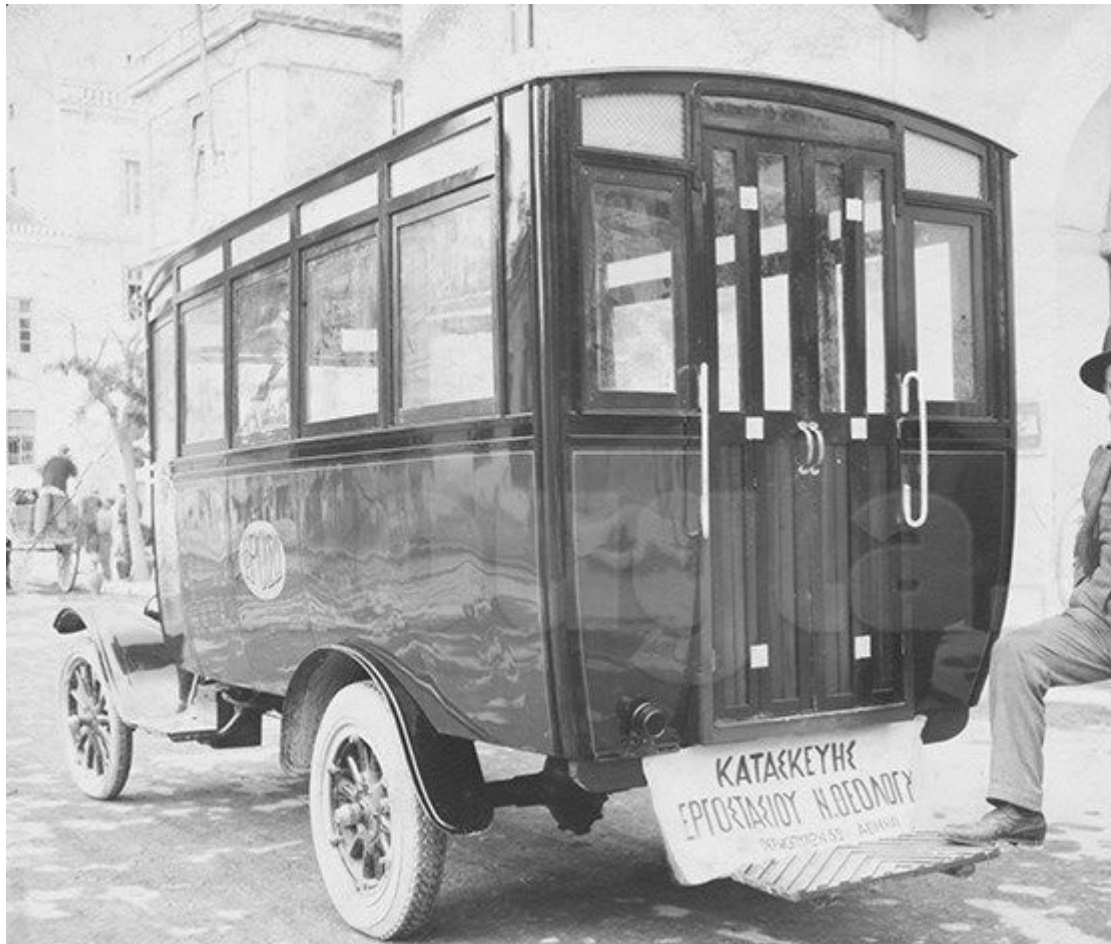
Ο Νίκος Θεολόγος κατασκεύαζε και διάφορα επαγγελματικά οχήματα ενώ είναι αυτός που εφεύρε τις πίσω πόρτες τύπου φουσαρμόνικα...
