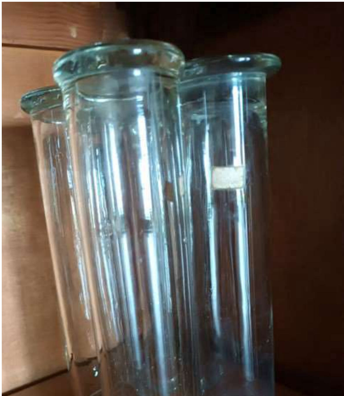
Εικόνα 2 Κύλινδροι με βάση από πλατυσμένο στόμιο. Τοποθετούνται ανάποδα για τη συλλογή αερίων
