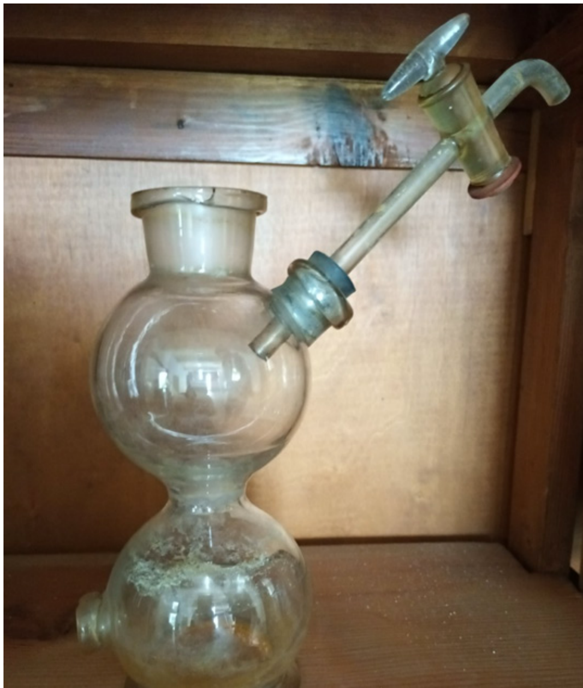
Εικόνα 1 Συσκευή παραγωγής αερίου, όπως παραγωγή ακετυλενίου από ανθρακασβέστιο με προσθήκη νερού
