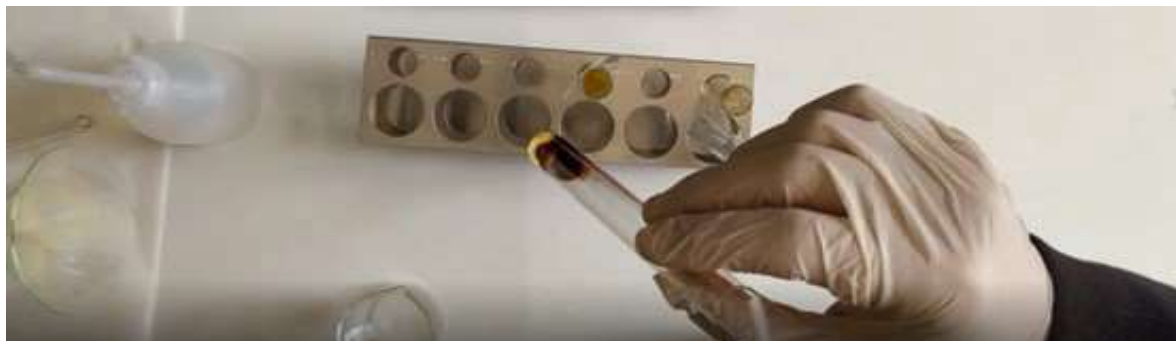
Εικόνα 3 Αντίδραση χλωριούχου σιδήρου με θειοκυανιούχα
