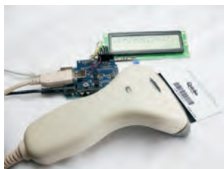
Εικόνα 3.9. Συσκευή γραμμωκώδικα με χρήση πλακέτας Arduino.
