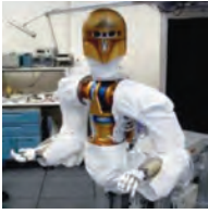
Εικόνα 3.26. Ο «ρομποναύτης» της NASA κατασκευάστηκε για την συντήρηση του διαστημικού τηλεσκοπίου HUBBLE.
