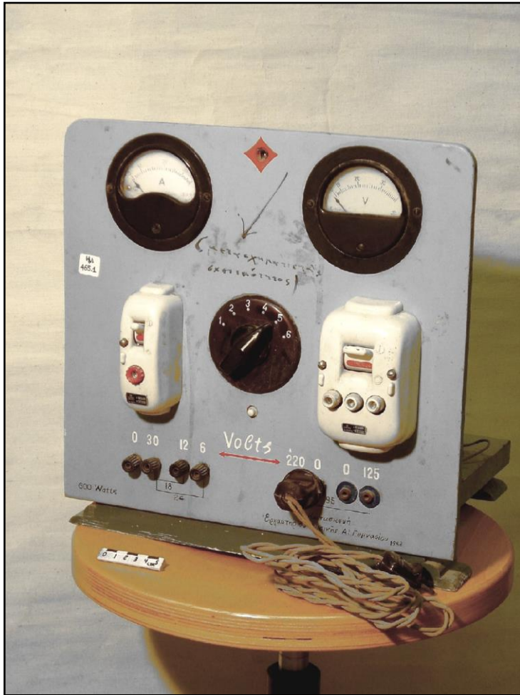
0-6-12-30V Τάση λειτουργίας 125 ή 220 V. Ιδιοκατασκευή ΣΤΡΑΤΗ ΠΑΠΑΝΗ- Φυσικού του σχολείου- 1958
