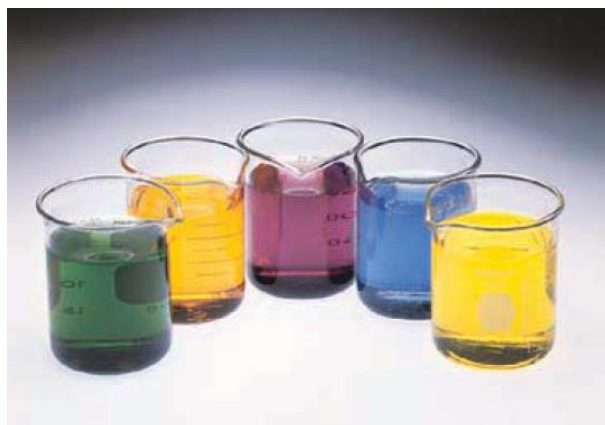
Υδατικά διαλύματα ενώσεων του Cr. Από αριστερά: CrCl_2 , K_2Cr_2O_7 , Cr(NO_3)_3 , CrCl_3 , K_2CrO_4 .
