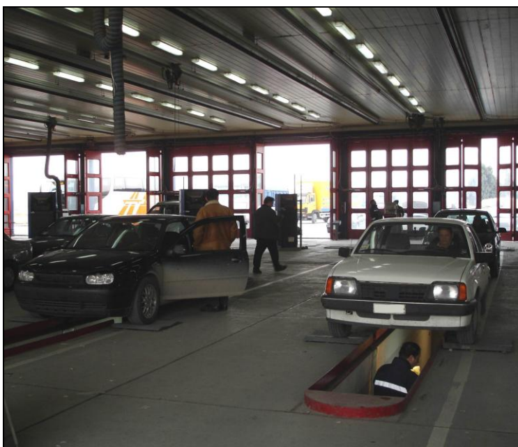
Εικόνα 61: Τα οχήματα εντός του ΚΤΕΟ εξετάζονται λεπτομερώς και από το κάτω τμήμα τους για τυχόν επικίνδυνες φθορές και βλάβες.
