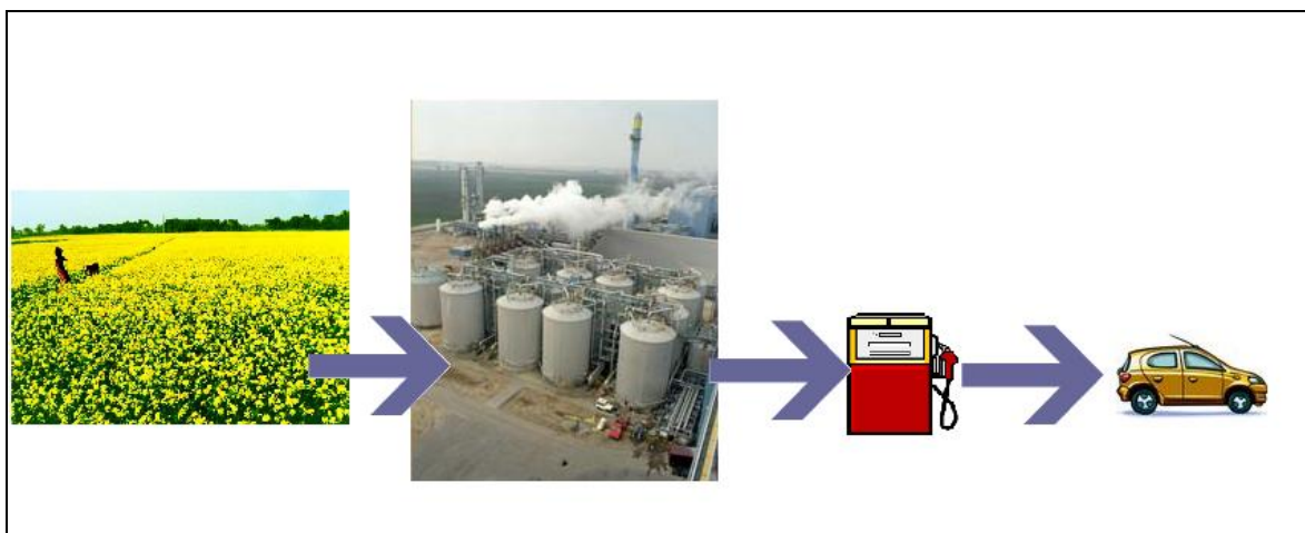
Εικόνα 30: Ο τρόπος παραγωγής των βιοκαυσίμων. Κατευθείαν από την γεωργική παραγωγή, σε εργοστάσια παραγωγής, στο πρατήριο καυσίμου (ως πρόσμιξη στην βενζίνη κίνησης) και τέλος στη δεξαμενή του οχήματός μας.
