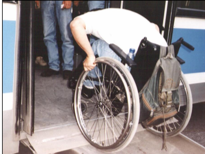
Εικόνα 20: Δυσκολία επιβίβασης ατόμου με αναπηρικό αμαξίδιο σε λεωφορείο λόγω μεγάλης κλίσης μεταξύ επιπέδου λεωφορείου και δρόμου (μη προσβάσιμο πεζοδρόμιο) (Πηγή: Naniopoulos et al., 1997).
