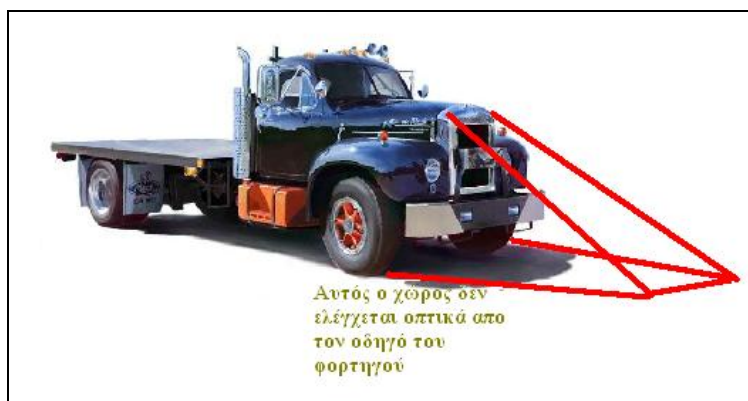
Εικόνα 13: Ο μπροστινός χώρος του φορτηγού που δεν ελέγχεται οπτικά από τον οδηγό.
