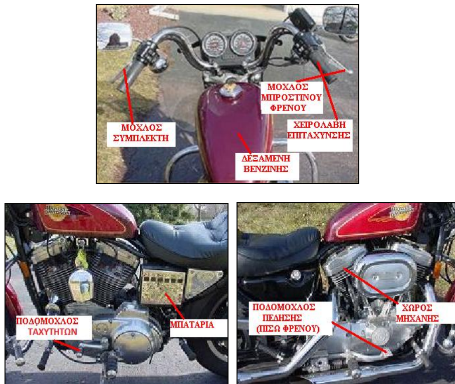
Εικόνα 21: Οι διάφορες όψεις μιας μοτοσικλέτας. Παρατηρείστε τη διαφορά στη θέση των βασικών μηχανισμών της μοτοσικλέτας.
