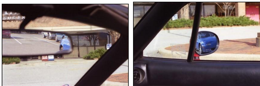
Εικόνα 71. Προσπέραση από δεξιά: Ένα μέρος του αυτοκινήτου φαίνεται ελάχιστα στον εσωτερικό καθρέπτη, αλλά φαίνεται καθαρά στο δεξί εξωτερικό καθρέπτη.
