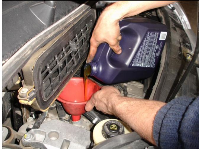
Εικόνα 4: Διαδικασία αλλαγής λαδιών στον κινητήρα.
