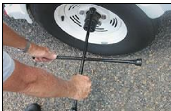
Εικόνα 26: Η σωστή χρήση του «σταυρού» για το ξεβίδωμα των μπουλονιών του τροχού.
