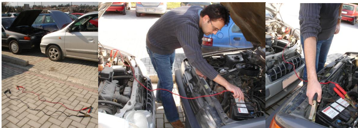
Εικόνα 22: Τοποθέτηση των καλωδίων για την αντιμετώπιση βλάβης της μπαταρίας. Τα οχήματα αντικριστά και τα καλώδια έτοιμα προς χρήση (αριστερά). Πρώτα συνδέουμε με το κόκκινο καλώδιο το θετικό πόλο του ανοιχτόχρωμου οχήματος που θα δώσει ρεύμα και μετά του σκουρόχρωμου που θα δεχτεί (μεσαία εικόνα). Στη συνέχεια με το μαύρο καλώδιο συνδέουμε πρώτα τον πόλο αυτού που θα δώσει και ένα μεταλλικό τμήμα του αμαξώματος αυτού που θα πάρει (δεξιά εικόνα).
