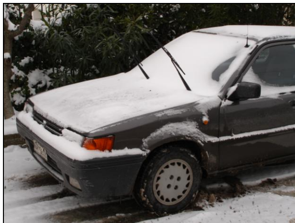
Εικόνα 66: Σε περίπτωση στάθμευσης σε χιονόπτωση, ανασηκώνουμε τα μάκτρα των καθαριστήρων, για να μην «κολλήσουν» κι ακινητοποιηθούν επί του ανεμοθώρακα («παρμπρίζ»).
