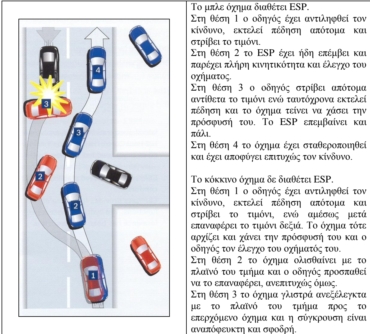
Εικόνα 69: Αποφυγή εμποδίου με απότομη πέδηση και προσπάθεια ελιγμού με και χωρίς ESP. ΠΡΟΣΟΧΗ: Στην περίπτωση που το όχημα δε διαθέτει ESP ή/και ABS, είναι φρονιμότερο κατά τον ελιγμό να αφήσετε εντελώς το φρένο (Πηγή: Electronic Brake Control Systems help to avoid accidents, BOSCH).
