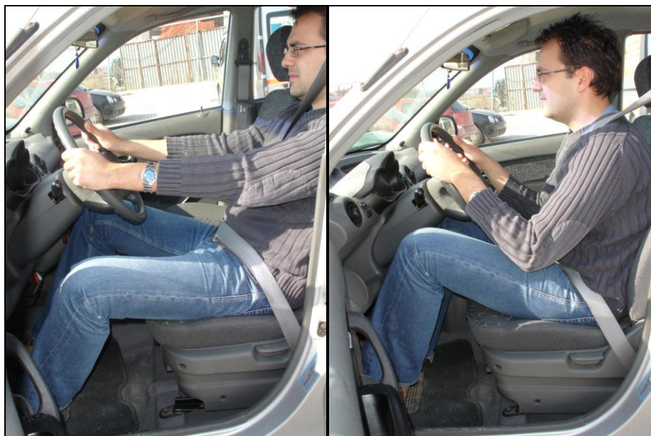
Εικόνα 18: Λανθασμένες θέσεις οδήγησης. Στην πρώτη (αριστερά) ο οδηγός βρίσκεται μακριά από τα χειριστήρια και συνεπώς δεν ελέγχει το όχημά του πλήρως. Στη δεύτερη (δεξιά) ο οδηγός βρίσκεται πολύ κοντά και έτσι δεν υπάρχει επαρκής χώρος για τους απαιτούμενους χειρισμούς.
