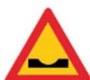
(Κ - 11) Επικίνδυνο κάθετο ρεϊθρο (αυλάκι) ή απότομη κοίλη αλλαγή της κατά μήκος κλίσης της οδού.
