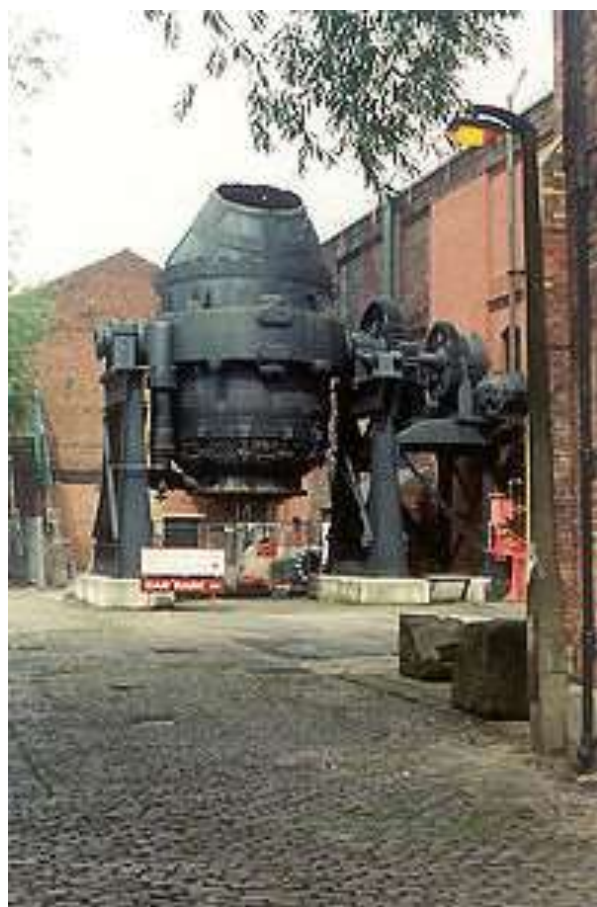
Εικόνα 4:Μεταλλάκτης Bessemer από παλιό χαλυβουργείο στο Σέφληντ της Αγγλίας.
