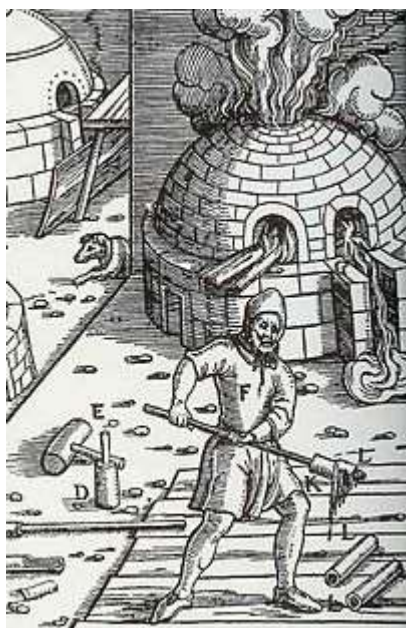
Εικόνα 3:Κυπέλλωση αργύρου από τήγμα αργυρούχου μολύβδου. Από το βιβλίο του γερμανού Georg Agricola De re metallica (Περί μεταλλικών πραγμάτων), 1556.
