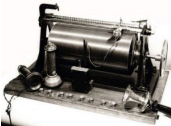
Τηλεγράφωνο του Poulsen, αρχική μορφή με κύλινδρο και βελτιωμένη μορφή με καρούλια.
