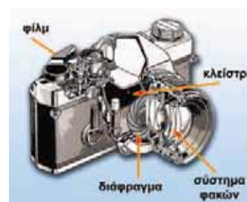
Εικόνα 9.17 Τα μέρη μιας φωτογραφικής μηχανής.
