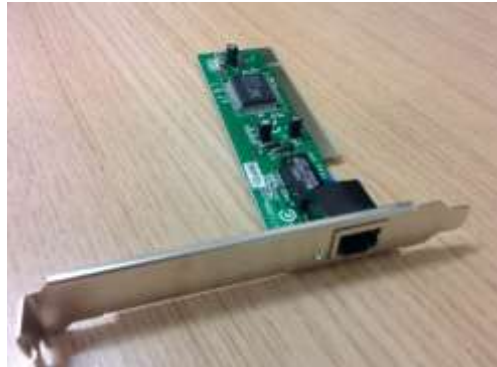
Εικόνα 147: Κάρτα δικτύου ethernet PCI
