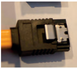
Εικόνα 266: Καλώδιο SATA με ασφάλεια
