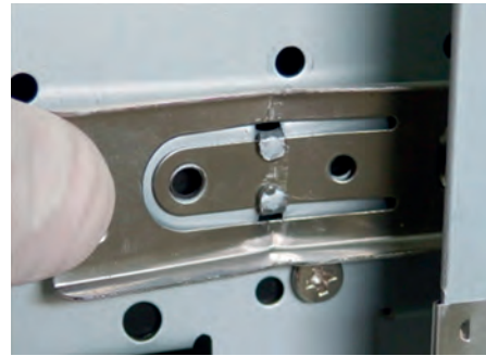
Εικόνα 33.Ελευθέρωση ελασματος συγκράτησης
