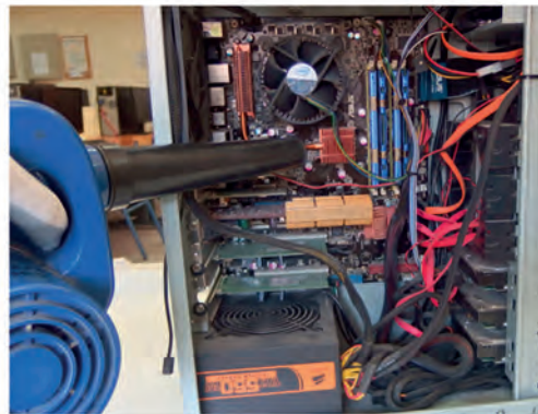
Εικόνα 68.Καθαρισμός με ηλεκτρικό φουσητήρα
