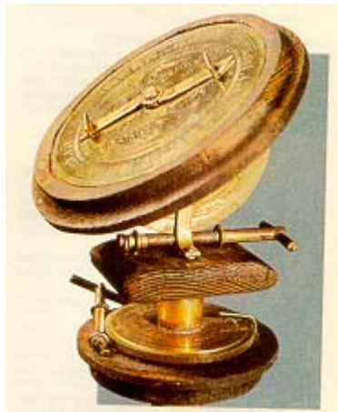
Σχήμα 1. Η γεωδαιτική διόπτρα του Ήρωνα. (Πηγή: Δούκας 2001)
