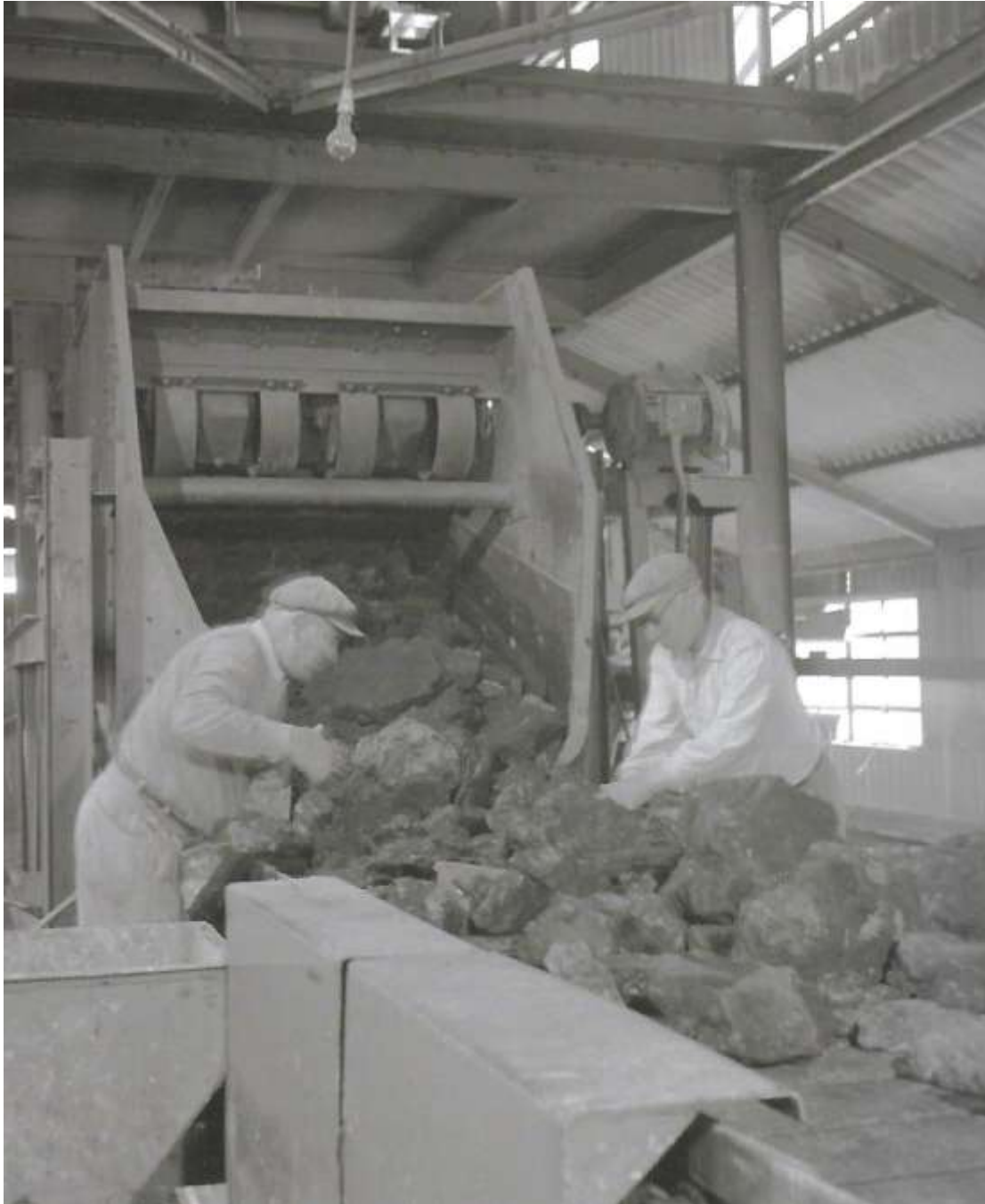
67. Διαλογή λιγνίτη. Εργαζόμενοι απομακρύνουν το μη καύσιμο υλικό (ΔΕΗ, Λεύκωμα, 60 χρόνια ενέργεια στην Ελλάδα, 1950-2010)
