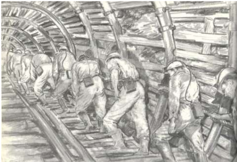
61.Βάρδια από λιγνιτωρύχους ανεβαίνει ένα φιρέ, πηγαίνοντας προς το μέτωπο εργασίας. Ο φιρές είναι μια στοά με κλίση, που οδηγεί στην επιφάνεια του εδάφους.
