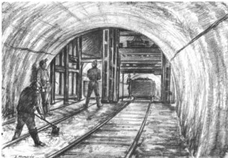
22.Δίδυμοι κλωβοί που ανεβάζουν τα γεμάτα και κατεβάζουν τα άδεια βαγόνια. (Λιγνιτωρυχείο Αλιβερίου σε σκίτσο Μεγαλίδη)
