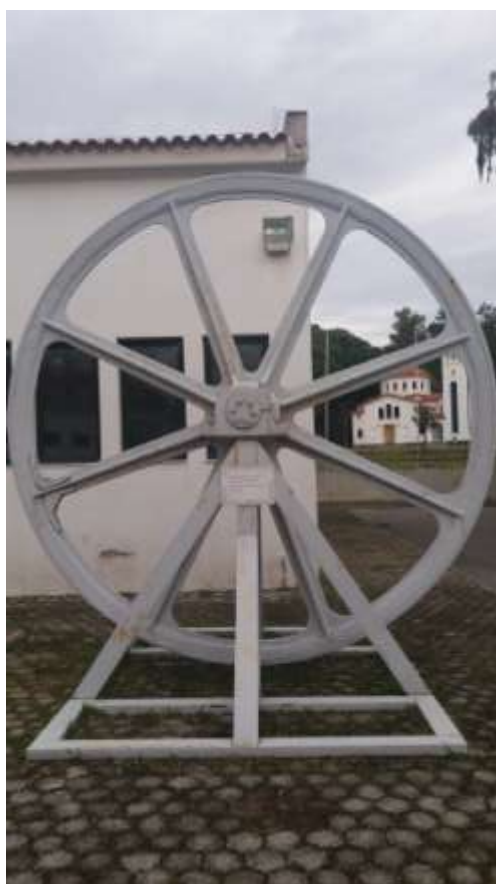
90.Τροχός Βαρούλκου θαλάμου ανελκύσεως-καθελκύσεως προσωπικού στις υπόγειες στοές του ορυχείου με την αντίστοιχη επιγραφή(Φωτ.Νεάκης.Κ)
