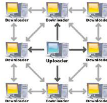
Εικόνα 10.4. Σε ένα δίκτυο BitTorrent όλοι λειτουργούν ομότιμα, χρήστες που ανεβάζουν υλικό (uploaders) και χρήστες που κατεβάζουν υλικό (downloaders).
