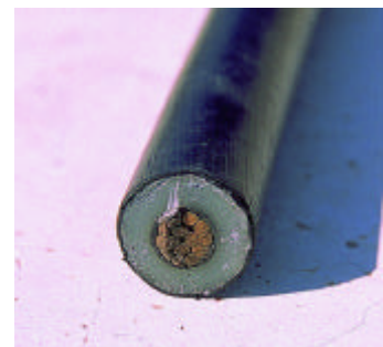
Καλώδιο μέσης τάσης
