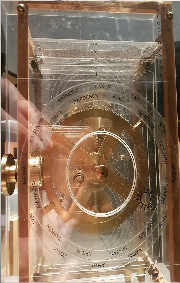
Αντίγραφο του μηχανισμού βάσει της ανακατασκευής του Ντέρεκ ντε Σόλα Πράις (μουσείο τεχνολογίας Θεσσαλονίκης)
