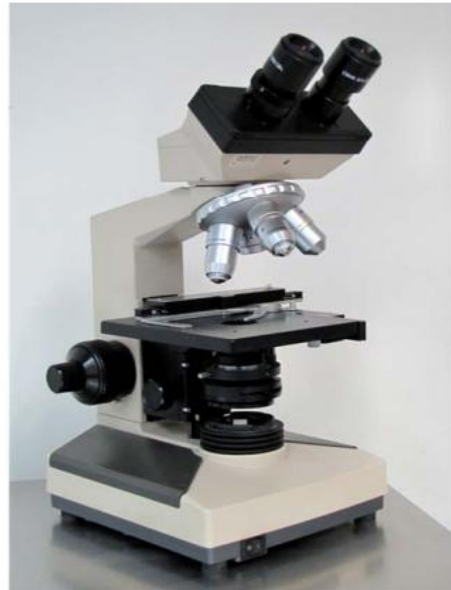
Εικόνα 1.5 – Σύγχρονο φωτονικό μικροσκόπιο ασκήσεων.
