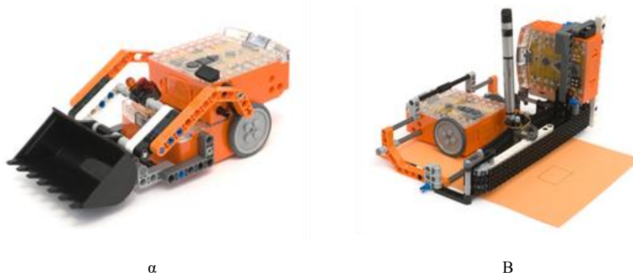
Σχήμα 7: Παραδείγματα ρομποτικών κατασκευών συνδυάζοντας δύο Edison ρομπότ και δομικά στοιχεία LEGO®: α) εκσκαφέας Edison - Lego και β) εκτυπωτής Edison - Lego.
