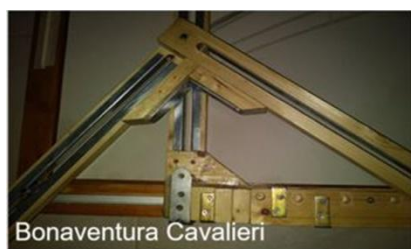
Εικόνα 3: Ο παραβολογράφος, ο ελλειψογράφος και ο υπερβολογράφος Cavalieri https://www.geogebra.org/m/rnkttmh9 & https://www.geogebra.org/m/eqqxcmx7
