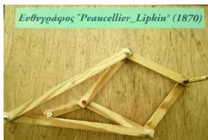
Εικόνα 2: Ο ευθυγράφος Peaucellier-Lipkin του EMM9ΓΛΠ - https://www.geogebra.org/m/t7qunmrf
