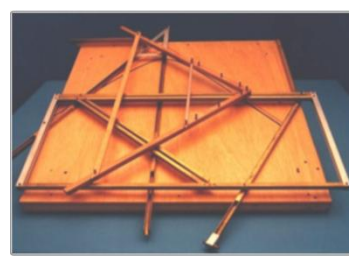
Εικόνα 3: Ο παραβολογράφος, ο ελλειψογράφος και ο υπερβολογράφος Cavalieri https://www.geogebra.org/m/rnkttmh9 & https://www.geogebra.org/m/eqqxcmx7
