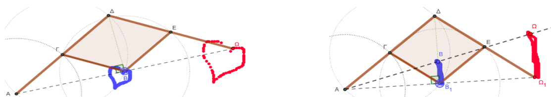
Εικόνα 7: προσομοίωση του παντογράφου Scheiner με το λογισμικό GeoGebra https://www.geogebra.org/m/skrdw4dk
